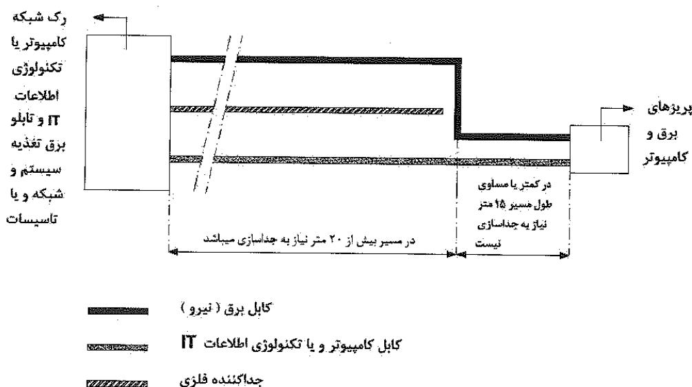
شکل ۱۳-۳-۱-۱۸-۲: طرحواره مسیر مجزا و مشترک کابل برق و کابل کامپیوuter یا فناوری اطلاعات IT برای طول مسیر بیش از ۳۵ متر
