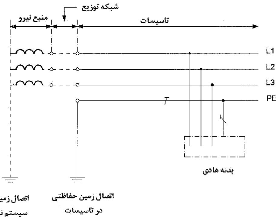
شکل پ ۱-۵ سیستم TT در سیستم سه‌فاز با هادی حفاظتی و بدون توزیع هادی خنثی در سرتاسر سیستم
