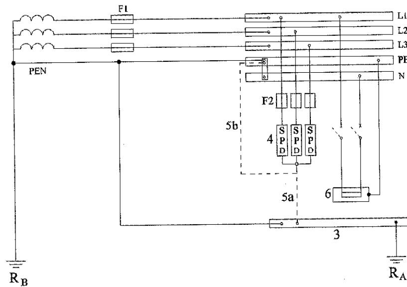
شکل ۱۳-۱-۴-۱۶-۱: طرحواره نصب برقگیر حفاظتی در شبکه توزیع سیستم نیروی TN (سه فاز)
