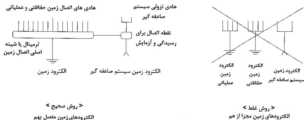
شکل پ-۱-۳-۸-۲-۱ طرحواره نحوه اتصال الکترودهای زمین حفاظتی، عملیاتی و صاعقه‌گیر
