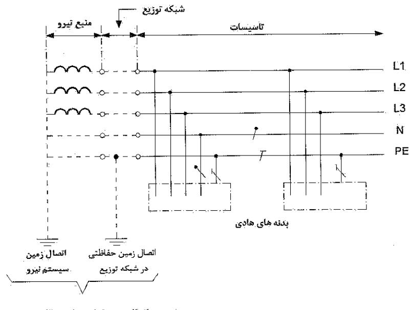
شکل پ-۱-۱: سیستم TN-S در سیستم سه‌فاز پنج سیمه با هادی‌های مجزای حفاظتی و خنثی در سرتاسر سیستم
