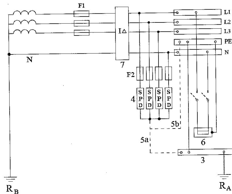
شکل ۱۳-۱-۴-۱۶-۱: طرحواره نصب برقگیر حفاظتی در شبکه توزیع سیستم نیروی TT با قرارگیری برقگیر حفاظتی در طرف تغذیه بار و بعد از کلید حفاظتی جریان باقی مانده (RCD)
