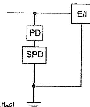
شکل ۳-۱۳-۳-۱۶-۱-۳ طرحواره نصب وسیله حفاظتی و برقگیر حفاظتی در تابلو برق تغذیه‌کننده دستگاه و یا تجهیزات
