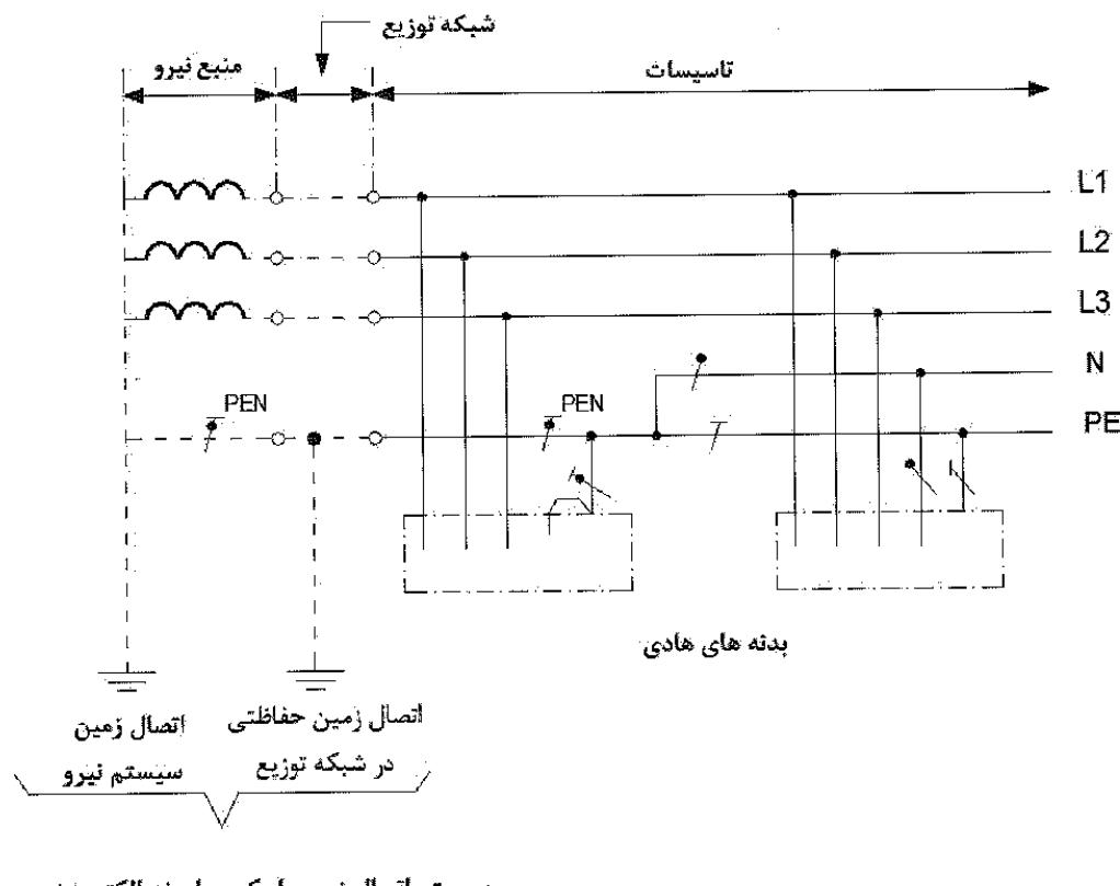
شکل پ-۱:۳ سیستم TN-C-S در سیستم سه فاز چهار سیمه که هادی مشترک حفاظتی خنثی، در بخشی از سیستم به هادی حفاظتی و هادی خنثی تفکیک شده است.
