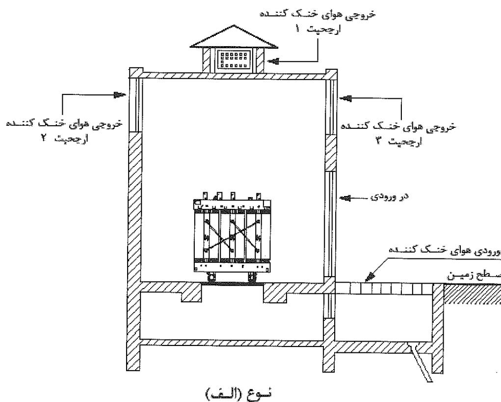
شکل ۱۳-۵-۳:۳ (نوع الف)- طرحواره مقطع قائم اتاق ترانسفورماتور خشک با تهویه طبیعی و هم سطح زمین
