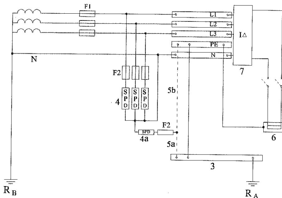
شکل ۱۳-۳-۱-۴-۱۶ طرحواره نصب برقگیر حفاظتی در شبکه توزیع سیستم نیروی TT با قوارگیری برقگیر حفاظتی قبل از کلید حفاظتی جریان باقی مانده (RCD)
