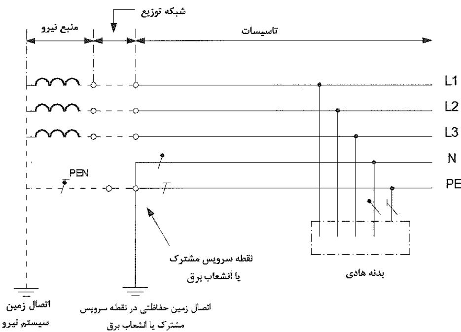
شکل پ ۴-۱-۱ سیستم TN-C-S در سیستم سه فاز چهار سیمه که هادی مشترک حفاظتی - خنثی، در نقطه سرویس مشترک یا انشعاب به هادی حفاظتی و خنثی تفکیک شده است.
