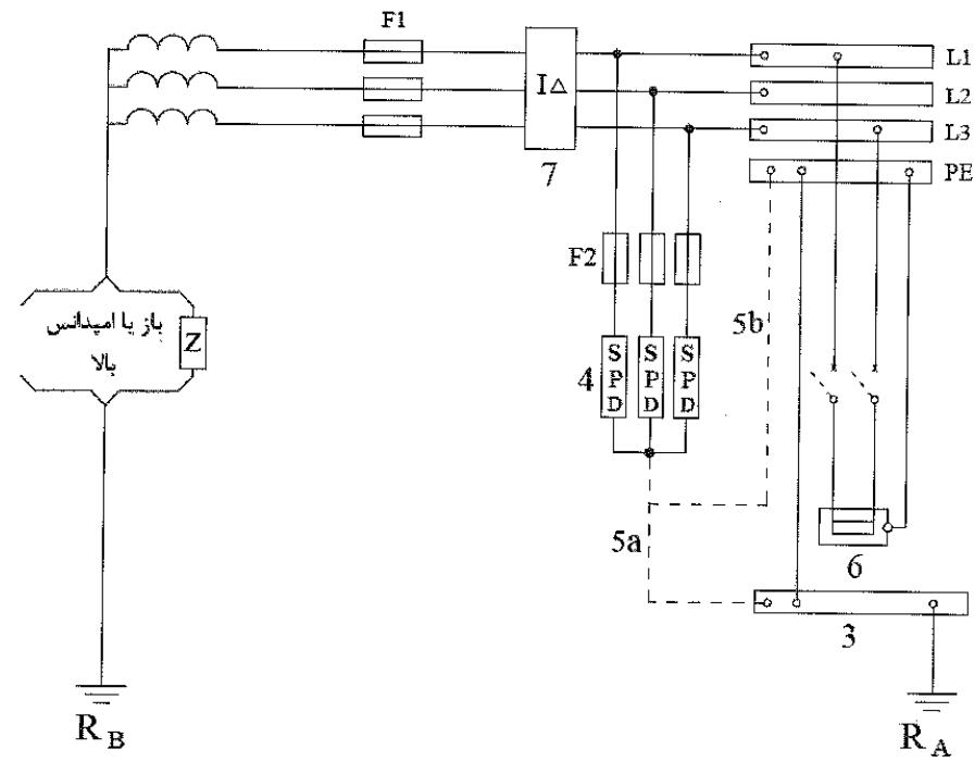
شکل ۱۳-۳-۱-۴-۱۶ طرحواره نصب برقگیر حفاظتی در شبکه توزیع سیستم نیروی IT
