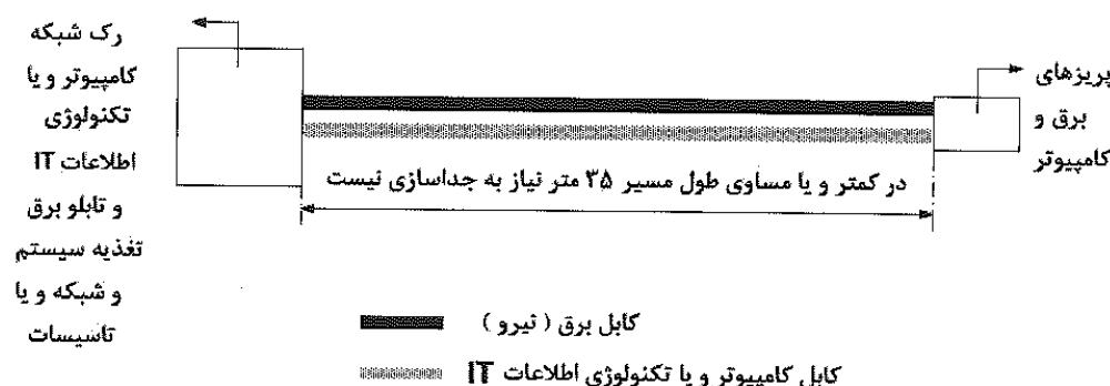
شکل ۱۳-۳-۱-۱۸-۱: طرحواره مسیر مشترک کابل برق و کابل کامپیوuter یا فناوری اطلاعات IT برای طول مسیر کمتر یا مساوی ۳۵ متر
